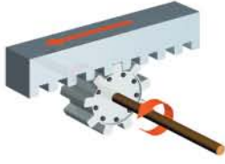
engrenage M à pignon M et crémaillère F rack and pinion gear engranaje M de piñón M y cremallera F Zahnstangengetriebe N ingranaggio M a pignone M e cremagliera F
